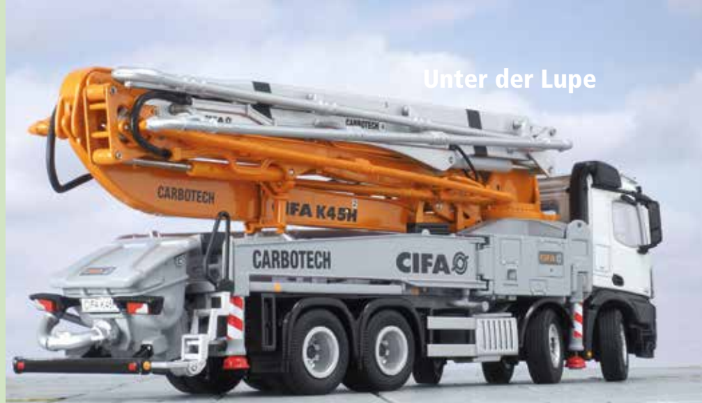
Die CIFA H45K mit den zwei farbig abgesetzten Verteilmast-Segmenten aus Carbon in Fahrtstellung.
