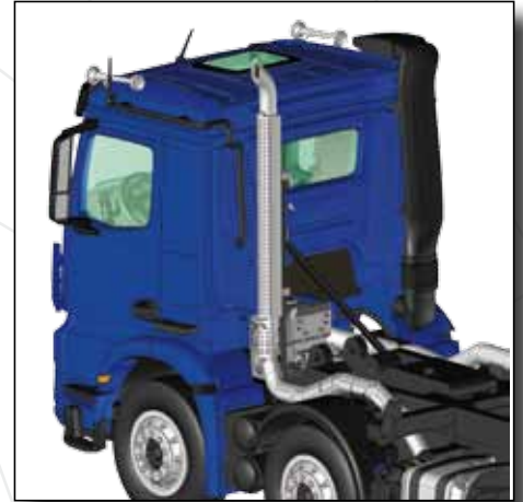
detaillierte Abgasanlage / detailed exhaust system
