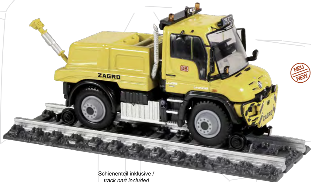
Mercedes-Benz Unimog U 400 Zagro Zwei-Wege Rangierfahrzeug / Two-way shunter „Deutsche Bahn“
