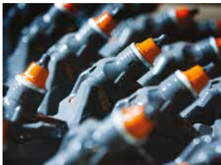
Uno degli elementi caratteristici che hanno segnato il successo del marchio Wirtgen è il rullo con la distribuzione elicoidale dei denti , a loro volta, a lunga durata e rapida sostituzione
